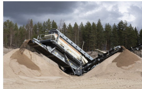
Verstellbare Förderbänder für hohe Halden.
