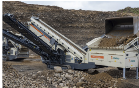
Großer Aufgabebunker ermöglicht einen geschlossenen Kreislauf.
