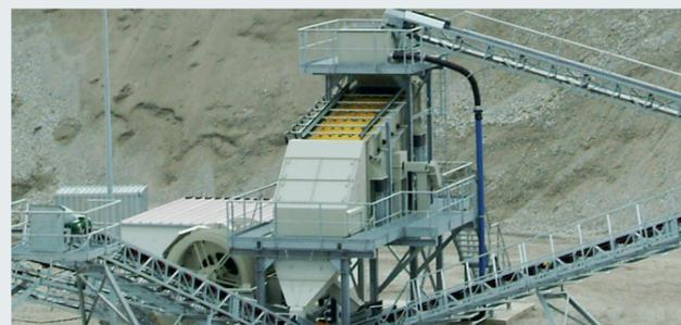
**STICHWEH-Aufbereitungsanlage mit EINDECKSIEBMASCHINE VS 15/40 DREIDECKSIEBMASCHINE VS 18/60**
