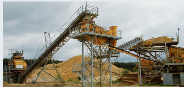
**STICHWEH-Aufbereitungsanlage mit EINDECKSIEBMASCHINE VS 15/40 ZWEIDECKSIEBMASCHINE VS 24/60 DREIDECKSIEBMASCHINE VS 15/50**
