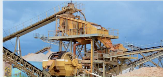
**STICHWEH-Aufbereitungsanlage mit ZWEIDECKSIEBMASCHINE VS 24/60**
